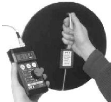
Die Sensorgeometrie und Kalibrierung des **EFS6** entsprechen der TCO-Richtlinie, ebenso verfügt das Feldmeter FM6 als Anzeigegerät über die in der Norm geforderte **Effektivwertgleichrichtung** des Messsignals.
